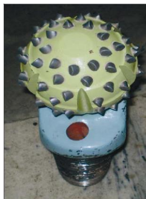
Рис.2.110. Общий вид одношарошечного долота с герметизированной маслonaполненной опорой
