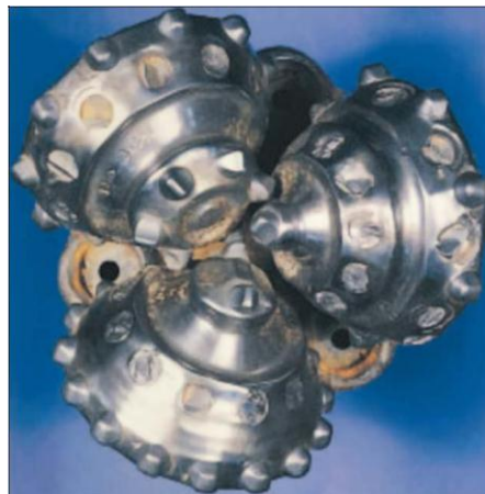
Рис.2.115. Общий вид отработанного долота, описанного в примере
