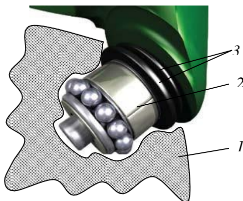
Рис. 1.56. Долото с двойным сальниковым уплотнением опоры качения: 1 – шарошка; 2 – цапфа; 3 – сдвоенные сальники.
