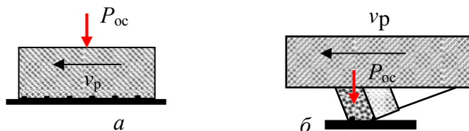
Рис. 1.36. Схема работы алмазных резцов импрегнированной коронки (а) и резца PDC (б)
